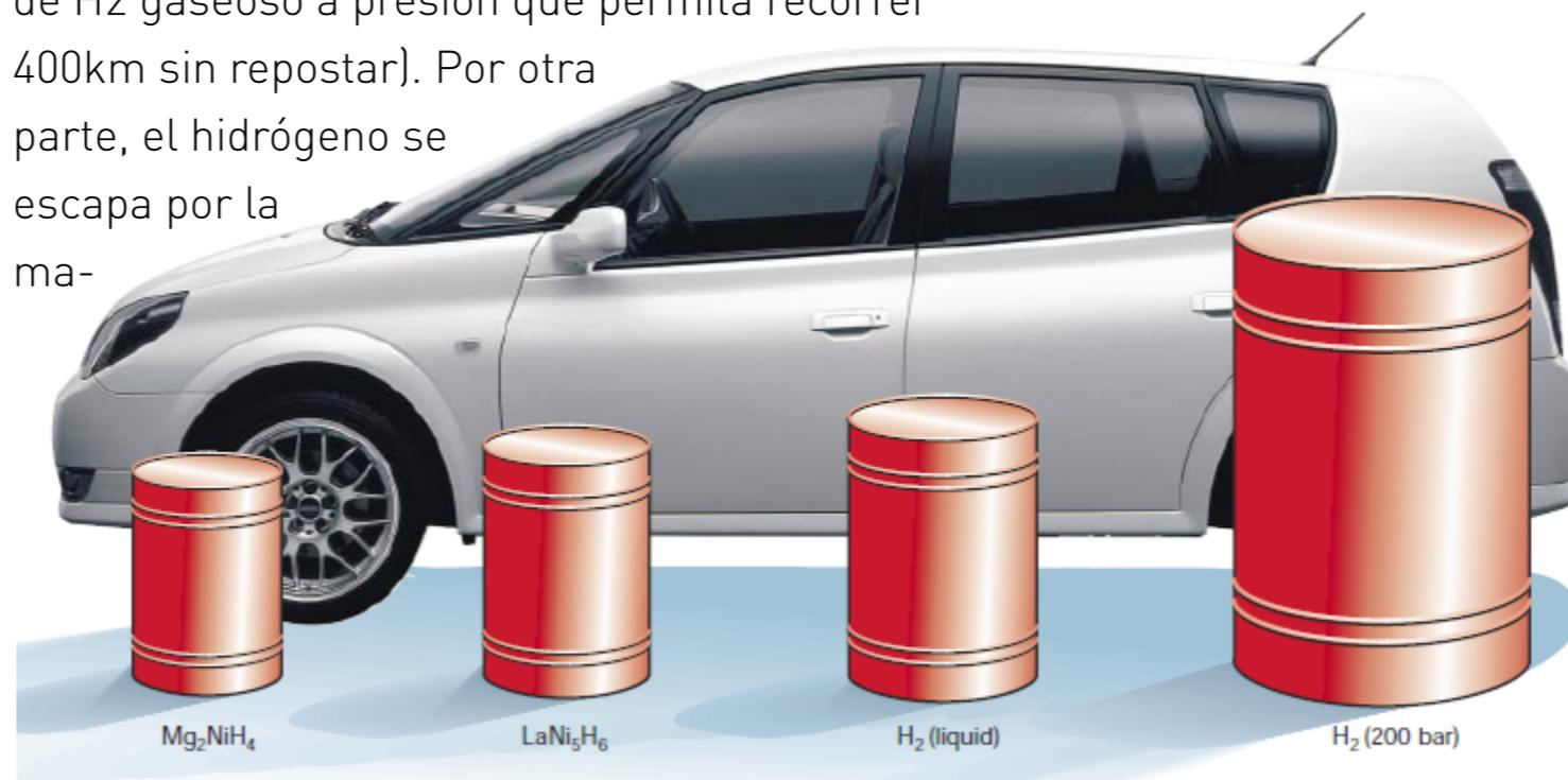
**Esquema del volumen que ocuparía: (de izq a derecha) tanques de almacenamiento sólido de hidrógeno (Mg<sub>2</sub>NiH<sub>4</sub>, LaNi<sub>5</sub>H<sub>6</sub>), tanque de almacenamiento líquido de hidrógeno y tanque de almacenamiento en forma de gas a presión para recorrer 400km.**
