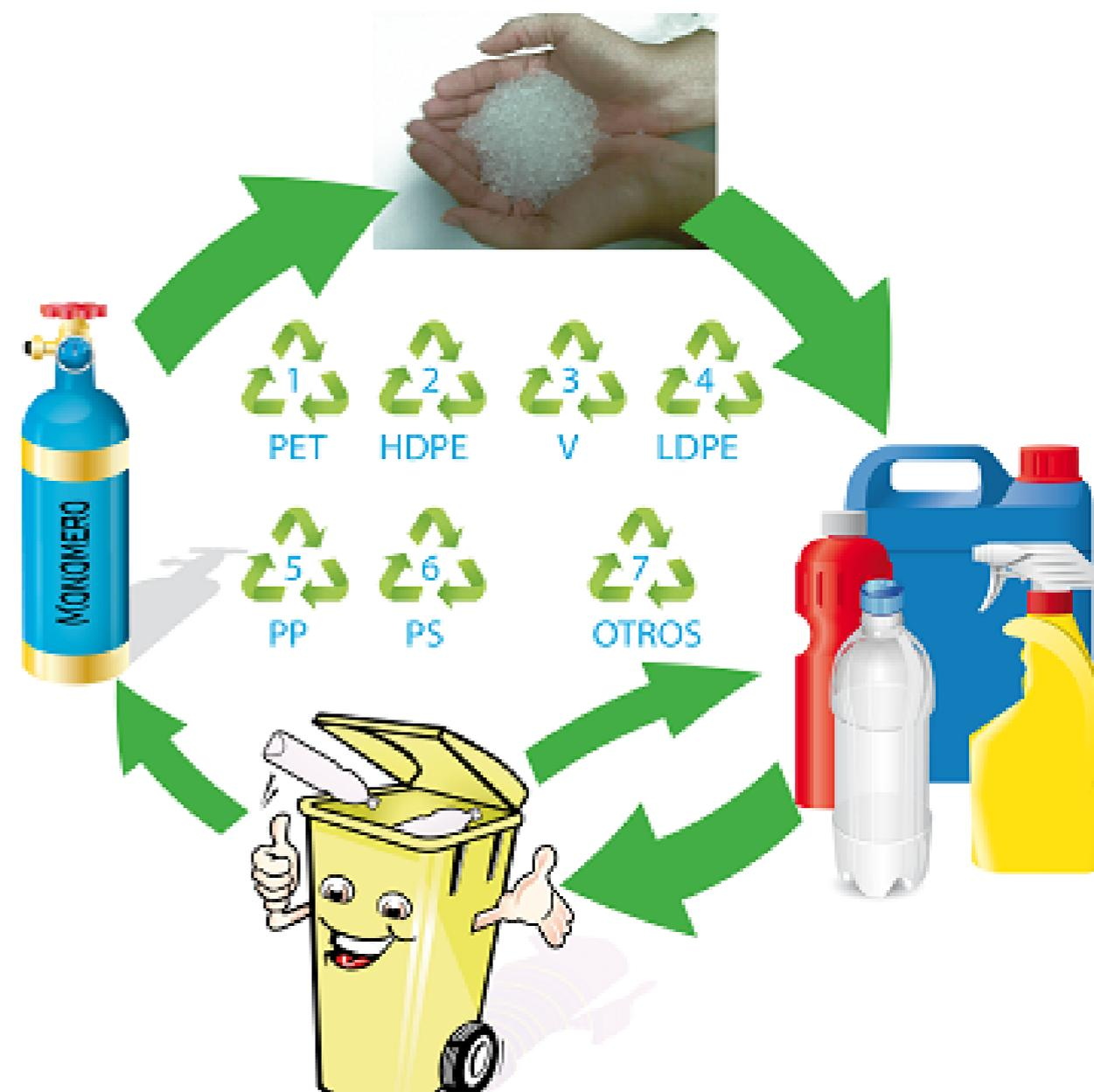
Figura 2. Ciclo de utilización de los materiales plásticos, y códigos de reciclado: PET, polietilentereftalato; HDPE, polietileno de alta densidad; V Cloruro de polivinilo; LDPE, polietileno de baja densidad; PP, polipropileno; PS, poliestireno.
