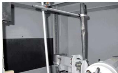
Figura 4. Tubo de órgano estudiado de forma no destructiva mediante difracción de rayos X en el ICMS. Dispositivo experimental.
