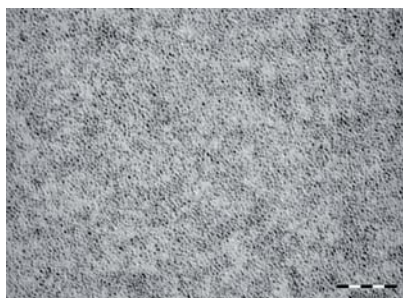
Figura 5. Imagen de nanopartículas de rutenio sintetizadas a partir de un compuesto organometálico.
