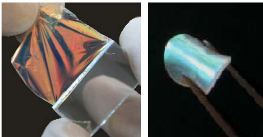
Figura 3. Fotografías de espejos flexibles formados por capas de nanopartículas cuyo espacio intersticial ha sido rellenado con un polímero. El color del mismo puede modificarse a través del grosor de las capas que la forman. (Imágenes reproducidas con permiso. Extraídas de Journal of Materials Chemistry 2009 , 19 , 3144)
